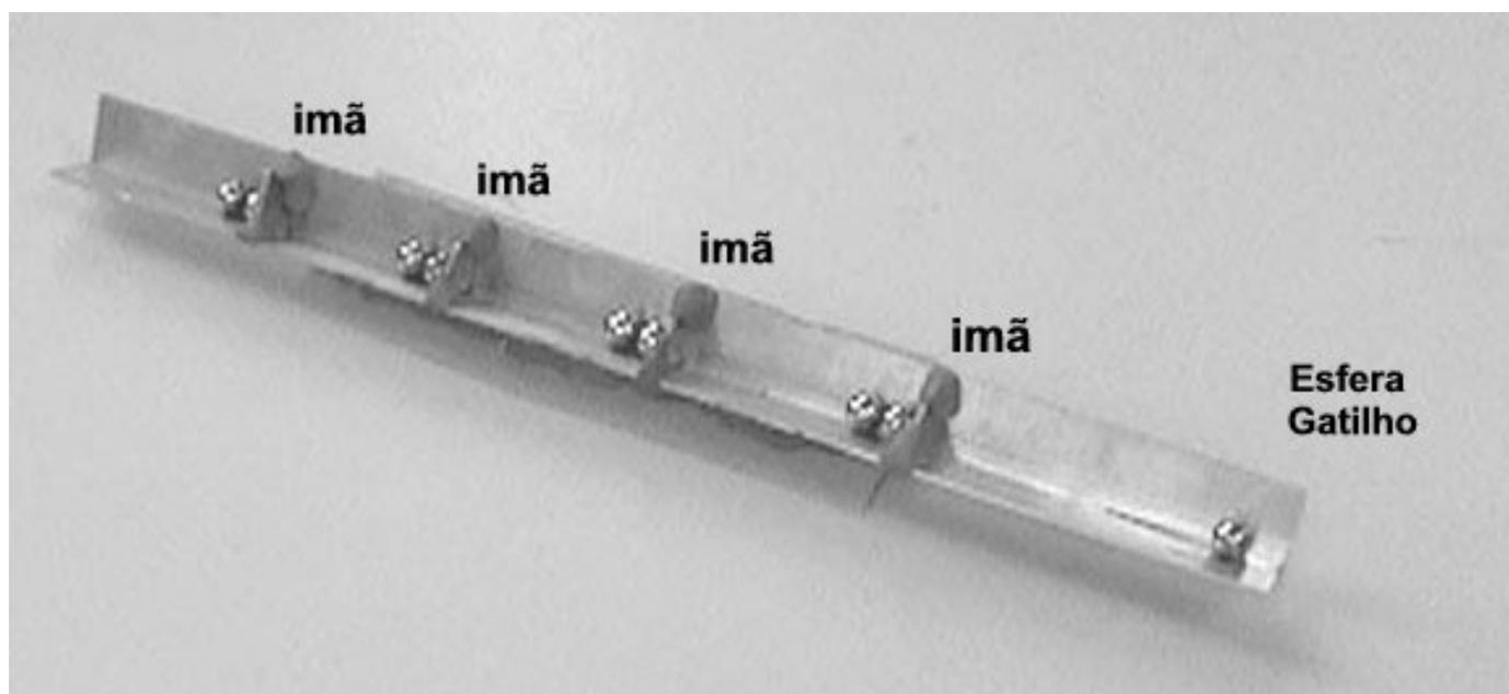
*Fig. 2 - Acelerador magnético montado com quatro ímãs.*
