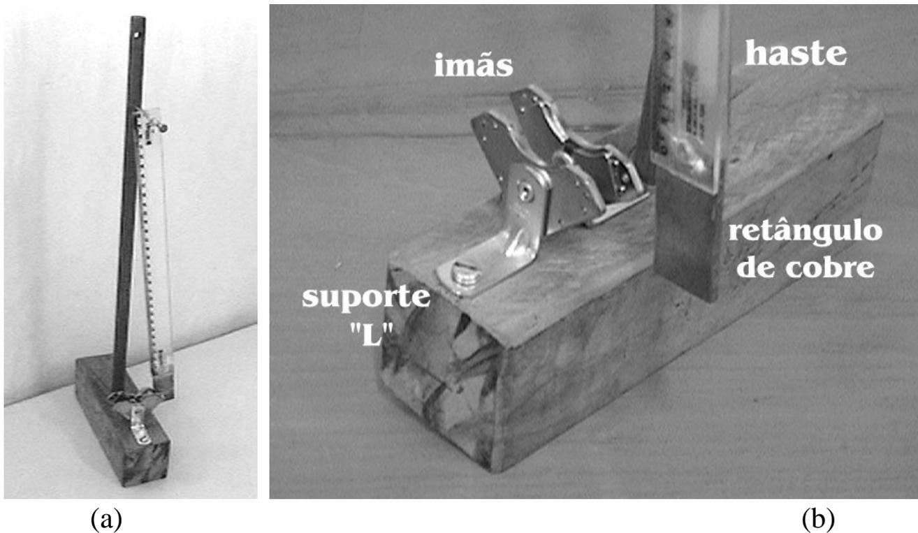
Fig 4- (a) Pêndulo montado. (b) Detalhe de sua base.
