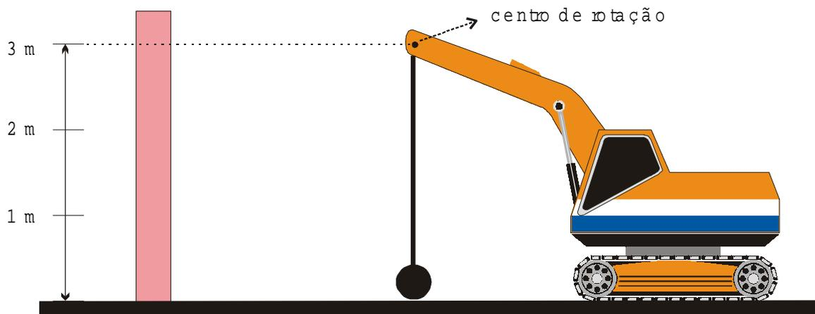
Conforme mostra a figura, a bola fica rente ao chão e gira em torno de um ponto situado 3 metros acima do chão.
