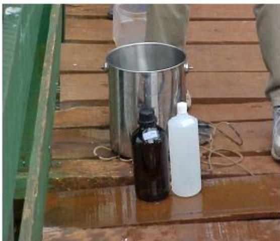
**Foto 9** – Detalhe balde de inox e frascos utilizados, na coleta
