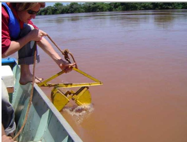
Figura 8: Amostrador de fundo tipo Van Veen.
