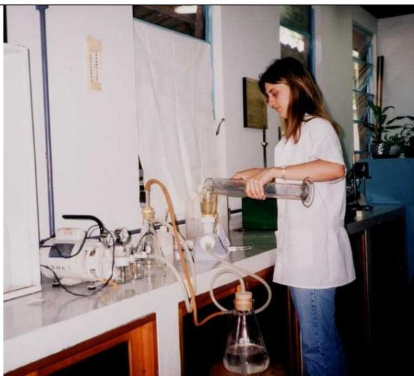
Figura 10: Material coletado sendo filtrado à vácuo.
