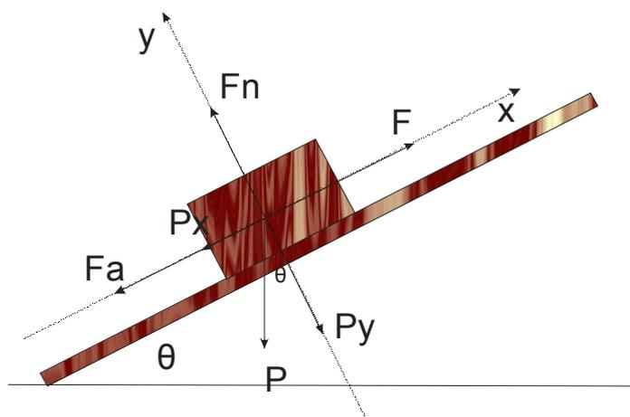
**Figura 20.** Forças e projeções no plano inclinado.
