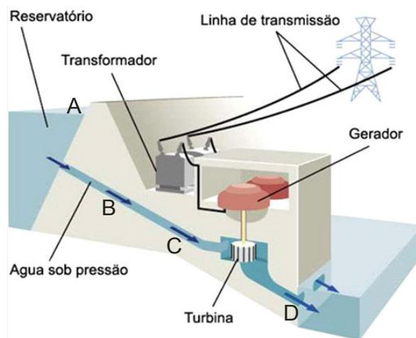
**Figura 15.** Esquema de uma usina hidrelétrica (Fonte: <http://marcia.carpinski.zip.net/images/eletricidade1.jpg> . Acesso em 25/09/09). Adaptado de SOUZA e ESPÍRITO SANTO, 2008a).
