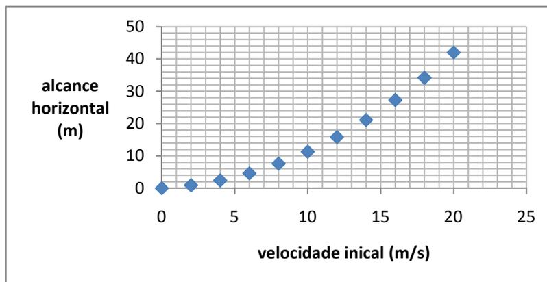
**Figura 22.** Gráfico referente ao Alcance horizontal em função da velocidade inicial da bala de canhão.
