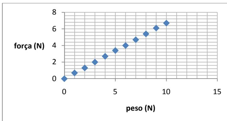
**Figura 19.** Gráfico da força necessária para puxar blocos de madeira em função do peso.
