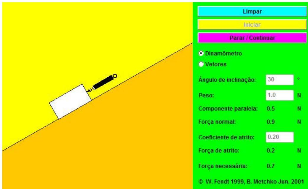
**Figura 18.** Simulação em Java de um plano inclinado (Fonte: [http://www.fisica.net/simulacoes/java/walter/ph11br/inclplane\\_br.php](http://www.fisica.net/simulacoes/java/walter/ph11br/inclplane_br.php). Acesso em 16/03/2010.
