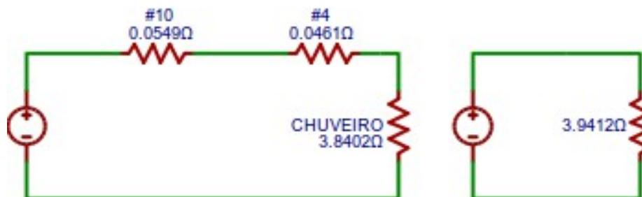
Fig.52- Circuito Série de um chuveiro com cabo #4
