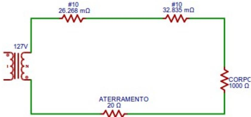
Fig. 24- Circuito elétrico de um corpo tocando um fio fase
