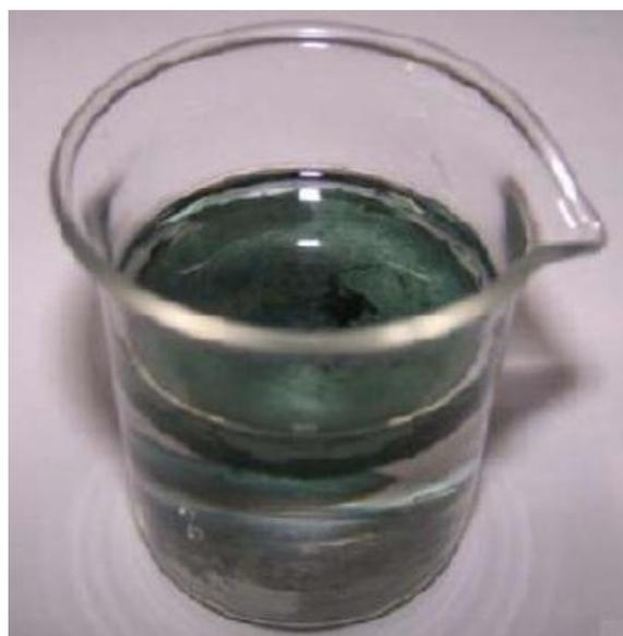
**Figura 17 – Béquer contendo polianilina com nanotubos de carbono na interface água/tolueno [59].**
