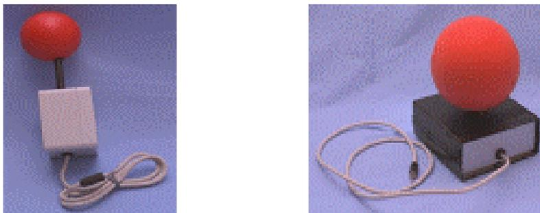
Fig14-15. Modelo de mouse com sensor tipo “bola” ( menor e maior)
