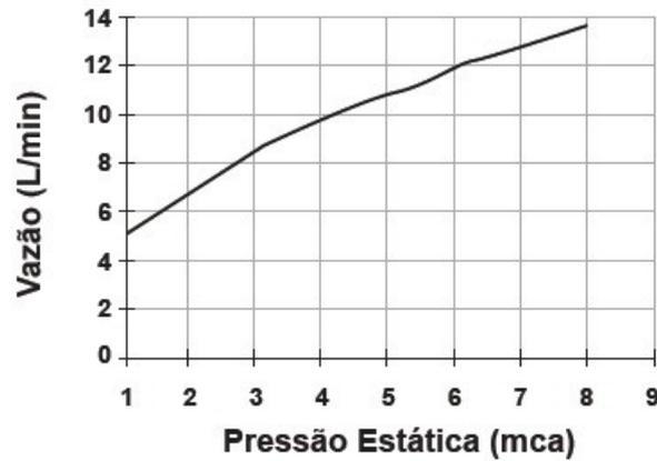
Nessa casa residem quatro pessoas. Cada uma delas toma um banho por dia, com duração média de 8 minutos, permanecendo o registro aberto com vazão máxima durante esse tempo. A ducha é instalada em um ponto seis metros abaixo do nível da lâmina de água, que se mantém constante dentro do reservatório. Ao final de 30 dias, esses banhos consumirão um volume de água, em litros, igual a
