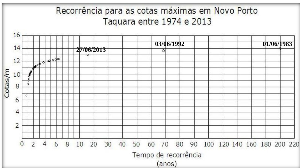
Figura 20: Tempo de recorrência calculado com base nas cotas fluviométricas máximas registradas na estação de Novo Porto Taquara no período de 1974 a 2013.
