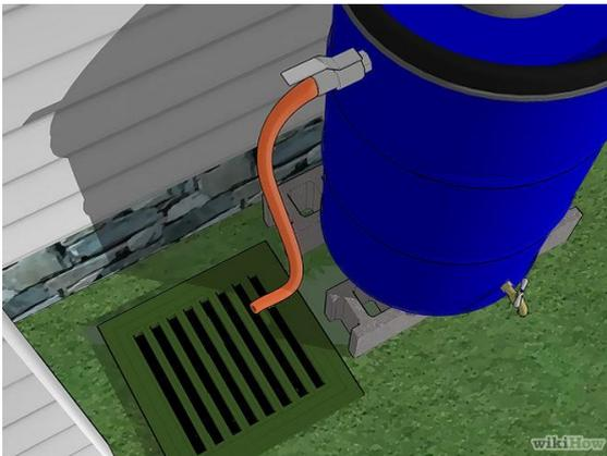
Com uma mangueira pequena, encaixe uma extremidade na válvula do ladrão, e a outra, coloque em direção ao ralo.
