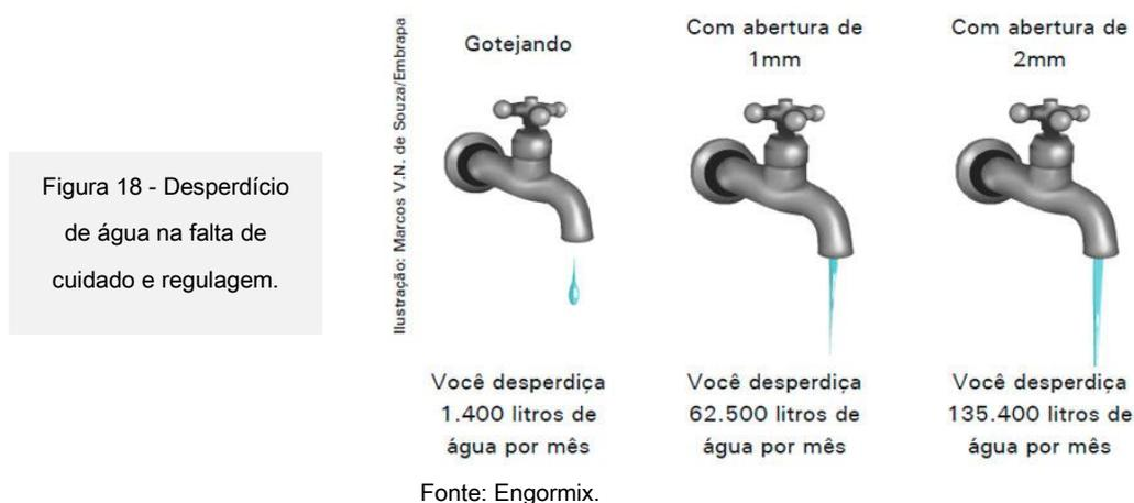
Figura 18 - Desperdiço de água na falta de cuidado e regulagem.
