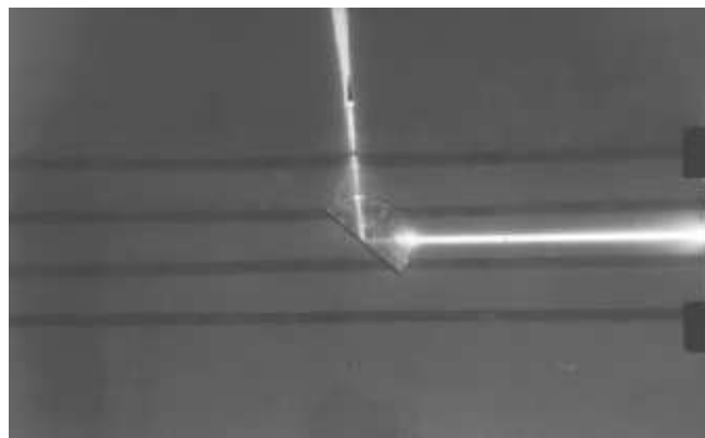
Figura 4. Semicírculo com incidência de um feixe num ângulo maior que o ângulo crítico, que resulta no processo de reflexão total interna.
