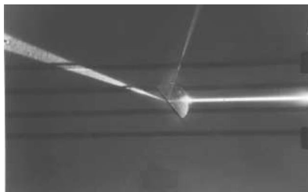
Figura 3. Semicírculo com incidência de um feixe num ângulo menor que o ângulo crítico. Aqui temos um feixe refratado e outro refletido na interface plana.
