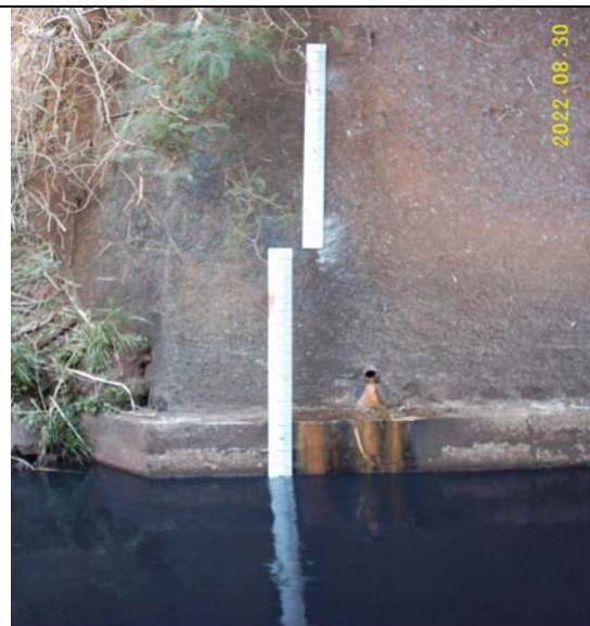
Figura 11 - Régua instalada na seção 4. Esta seção está situada após a estação de tratamento de esgoto da SANEPAR. Note a coloração da água
