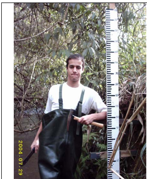
Figura 6 - Instalação de régua no córrego Romeira seção 2
