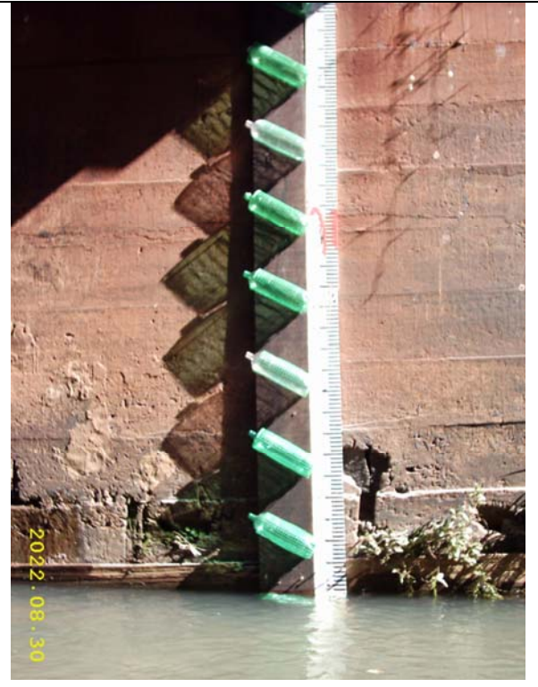
Figura 9 - Detalhe da armadilha construída com garrafas PET. Sentido do fluxo para a direita
