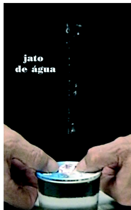
Figura 2. Jato produzido por uma leve compressão na tampa.
