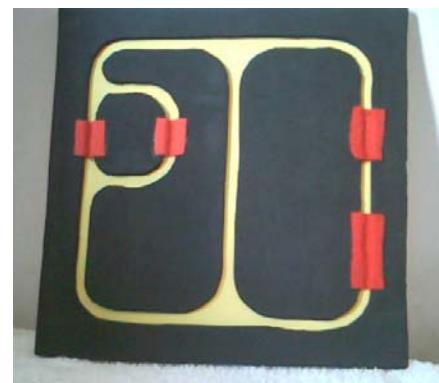
Figura 3 - Material utilizado para ensinar conceitos de resistência em série e em paralelo.
