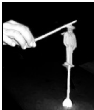
Fig. 2 – Teste do Eletroscópio Lúdico “Homenzinho”.
