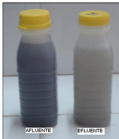
Figura 2: Material afluente e efluente do reator UASB
